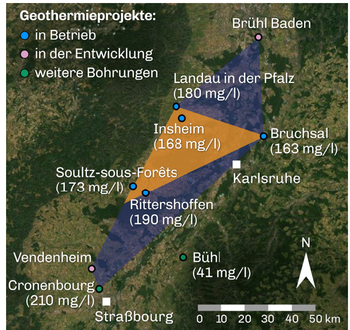
Abbildung 1: Lithiumverteilung im Oberrheingraben: das orange markierte Gebiet bildet das geothermische Lithiumdreieck, welches durch nachhaltige Lithiumkonzentrationen gekennzeichnet ist. Die blaue Fläche umfasst dabei alle geothermischen Standorte mit Lithiumgehalten über 150 mg/L.
